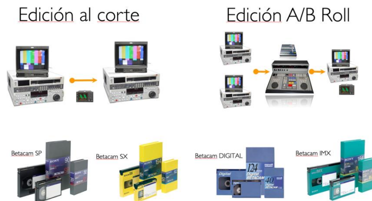
Figura 10: Esquema de antigua edición lineal analógica A/B Roll con unidad de control BVE-600 y distintos formatos de cintas analógicas de uso profesional. Elaboración propia a partir de imágenes de los fabricantes.
