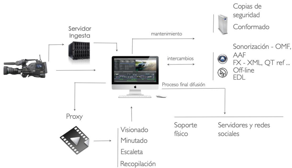
Figura 7: Esquema de un posible flujo de trabajo audiovisual y sus fases de postproducción. Fuente: Elaboración propia a partir de imágenes de los fabricantes.
