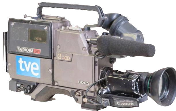
Figura 10: Cámara profesional Camcorder Betacam SP utilizada en producción televisiva ENG. Fuente: Museo RTVE (2017).
